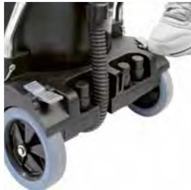
Die Feststellbremse kann beidseitig betätigt werden und verhindert ein ungewolltes Wegrollen des Saugers.
